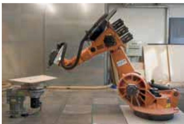
Besonders interessiert sich die Besucher für die Details zum Forstpavillon selbst. Mit großem Erstaunen nahmen sie zur Kenntnis, dass die Tragkonstruktion des Holzgebäudes aus 243 verschiedenen, ineinandergesteckten Segmenten besteht und ein Industrieroboter dazu 7.300 Fingerzinken millimetergenau fräste.
