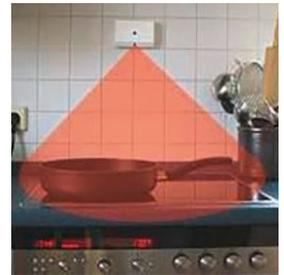
ab. Gefahrensignal erfolgt über LED und Signalton. Das Gerät ist für alle Elektroherde geeignet und erfordert aufseiten des Herdnutzers keine aktive Bedienung.
